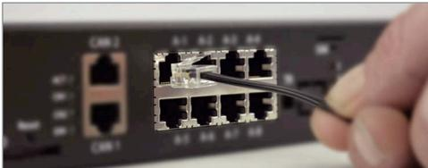
**Abb.:** Plug `n` Play Montage der analogen Zertico Sensoren. Per AutoSense Funktion wird der Sensor sofort erkannt.
